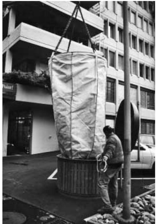
verlängern die Entleerungsintervalle. Der Molok verbessert zudem die Hygiene. Die natürliche unterirdische Erdkühle verlangsamt den Fäulnis- und Gärungsprozess in den Behältern und vermeidet Geruchsbelästigungen.
