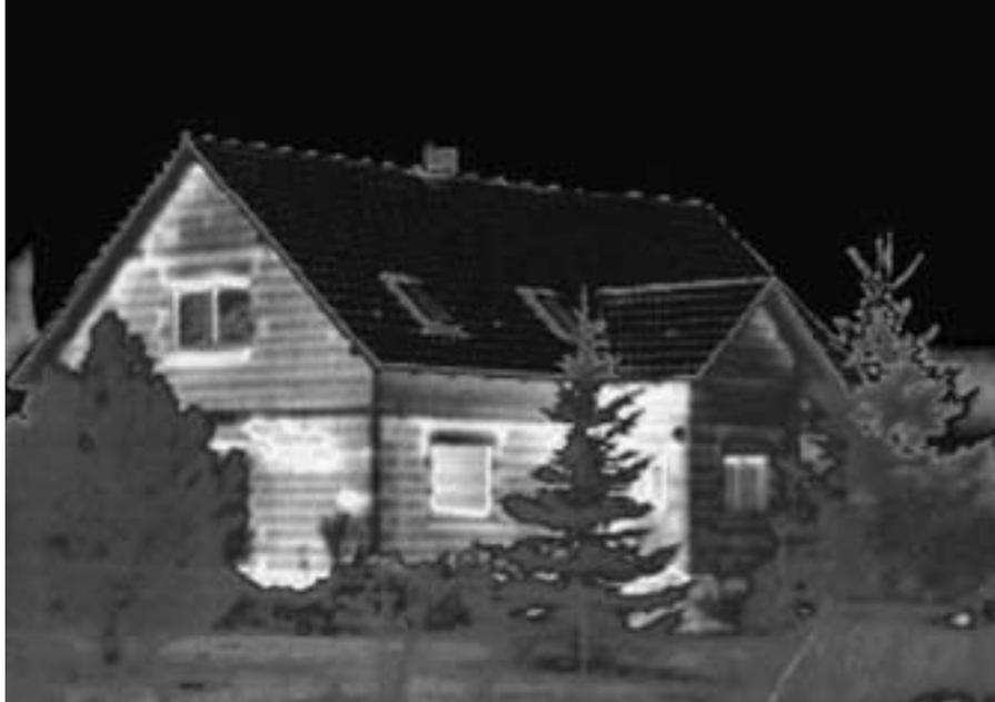
*Thermografieaufnahme: Wärmedämmung der Gebäudehülle bildlich festgehalten.*
