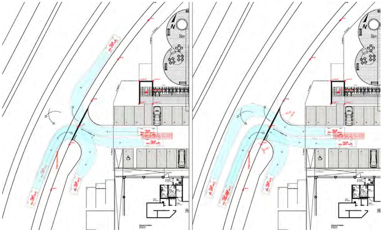
Abb. 23: Schleppkurvenprüfung Zu- und Ausfahrt Heldastrasse
