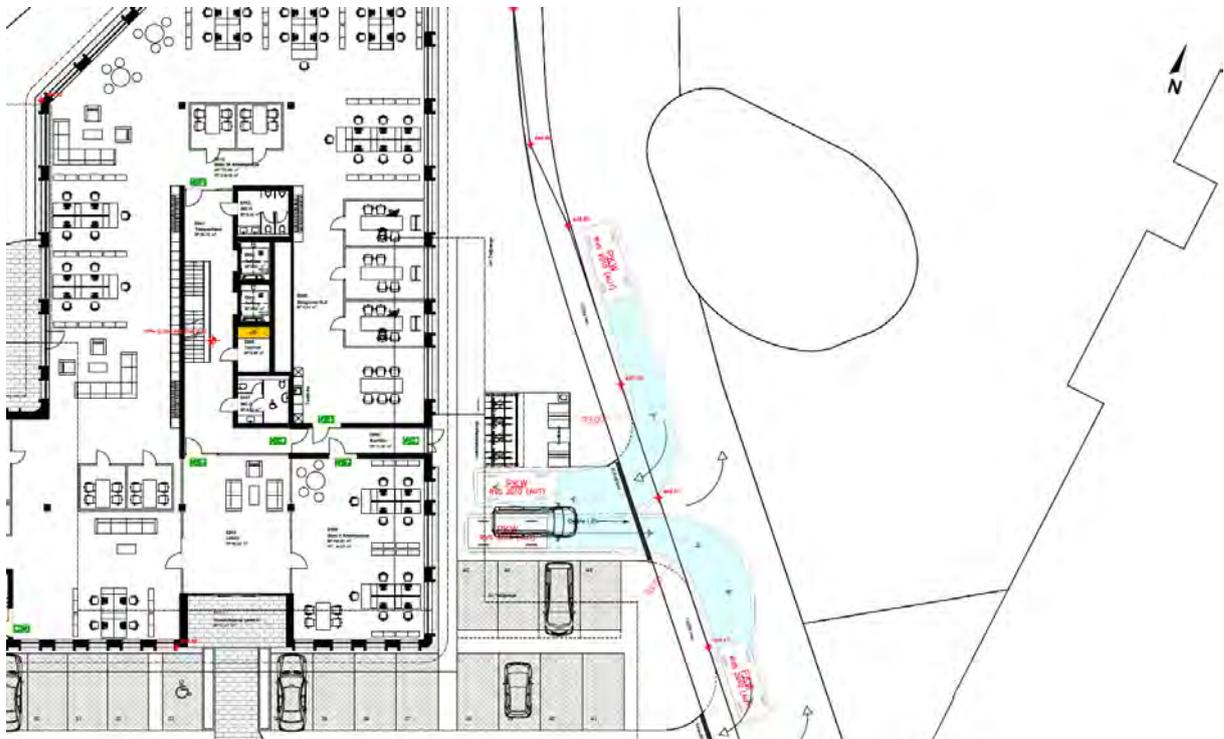
Abb. 22: Schleppkurvenprüfung Zu- und Ausfahrt Lieferanteneingang
