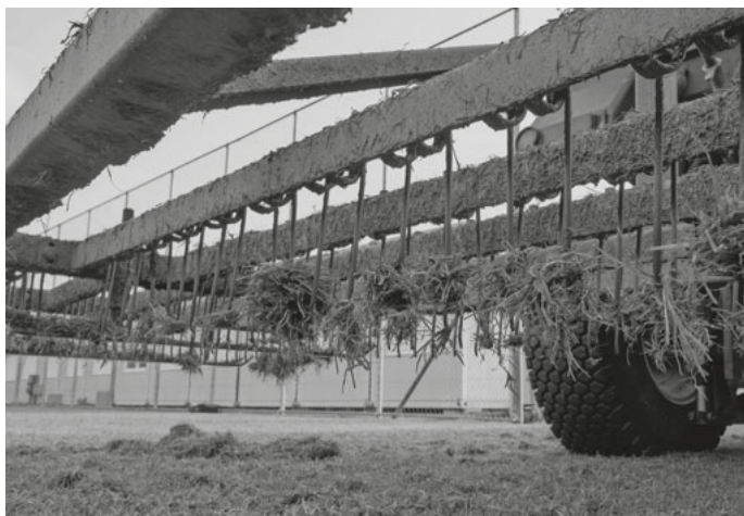
Der Rasenstriegler (Bild links) belüftet die Grasnarbe. Nach dem Striegeln kommt jeweils auch der Traktorrasenmäher zum Einsatz. Das Schnittgut wird in eine Mulde gekippt (Bild rechts) und zur Kompostieranlage geführt.
