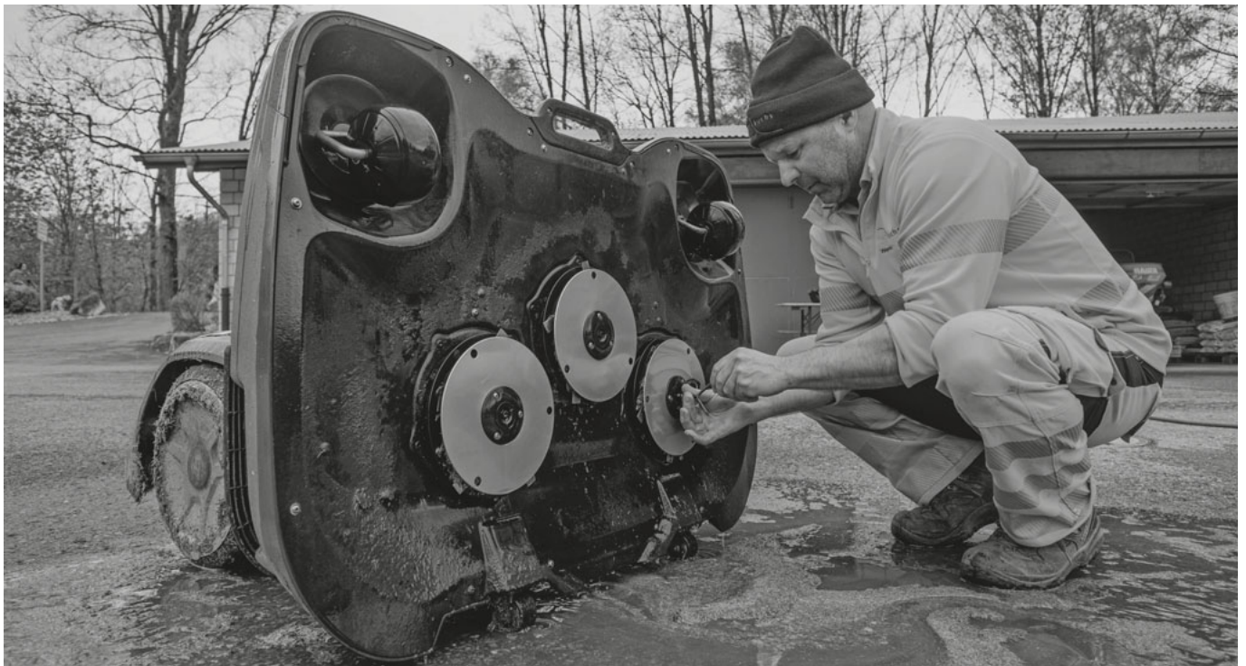
Bruno Barmet reinigt den Grossflächenmäher, der auf den Fussballplätzen in der Rheinau im Einsatz ist. Per Handy kann der Mitarbeiter des Werkhofs diesen Roboter steuern.
