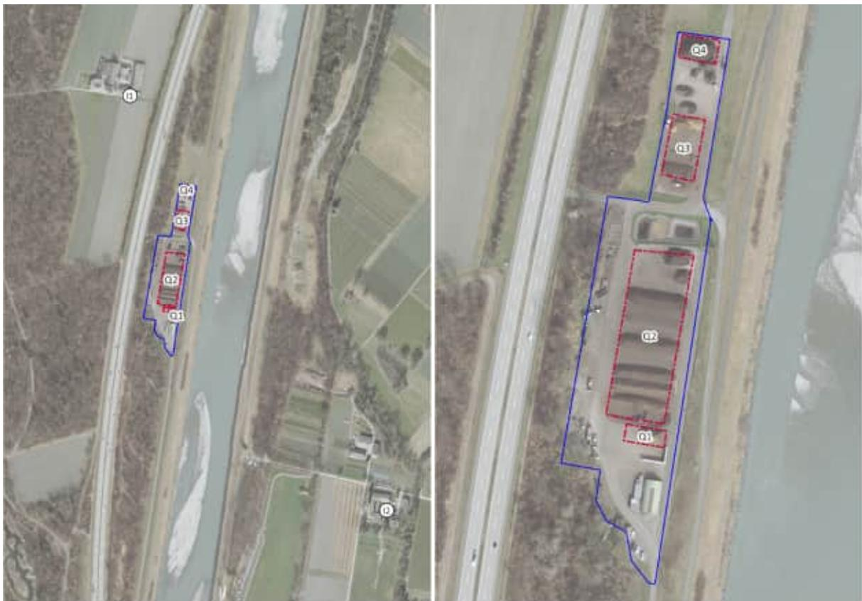
Abbildung 21: Links: Übersicht zu den Geruchsquellen (rot umrandete Flächen, Q1 bis Q4) und Immissionspunkten (I1 bis I2); rechts: Lage der geruchsrelevanten Flächen (Detail).
