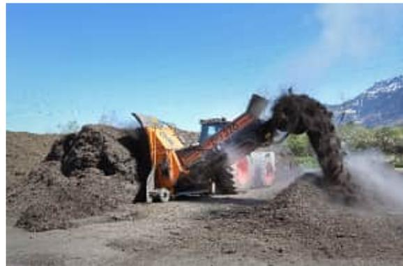
Umsetzen der Rottemieten. Einsatz Traktor mit Kompostumsetzer.
