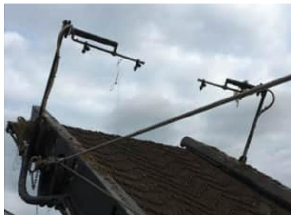
Abbildung 24: Technische Einrichtungen zum Einsatz von Compazym K. Links: Gebläse zum Besprühen des Zwischenlagers von Hofdünger (Hühner- und Pferdemit); rechts: Düsenbalken zum Besprühen des geschredderten Grüngutes. 11.09.2017. Fotos: KBA.
