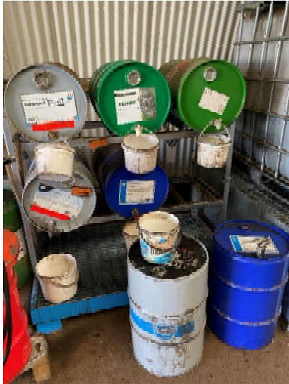
Abbildung 34: Motoren-/Hydrauliköl – Lagerung über Auffangwanne. 24.10.2022. Foto: KBA.
