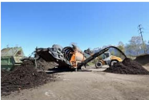
Aussieben Kompost. Einsatz Radlader und Trommelsieb mit Magnetabscheider und Windsichter.
