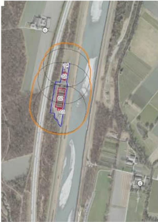
Abbildung 22: Mindestabstand von der Anlage (orange), Mindestabstände zu den einzelnen Quellen (schwarz gestrichelt) und Lage der Immissionspunkte I1 und I2. Blau: Geltungsbereich der Kompostieranlage, rot: geruchsrelevante Flächen.
