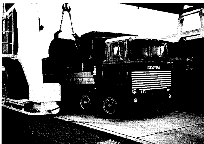
Güterumschlag Bahn/Auto: Stahlblechrollen für die Firma Elkuch AG
